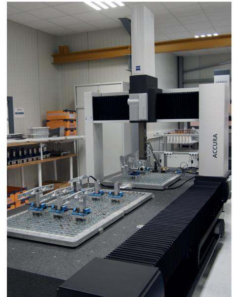
› Le laboratoire se compose de trois MMT Zeiss
